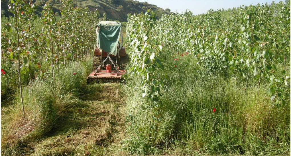
**Figura 45. Desbrozadora de cadenas de eje vertical**
