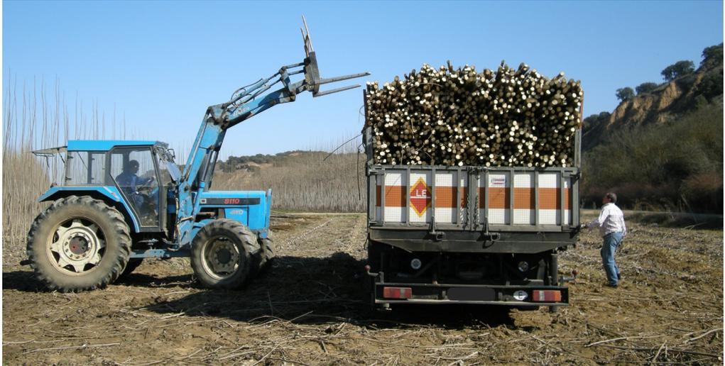
**Figura 82. Tractor con apero cargador frontal**
