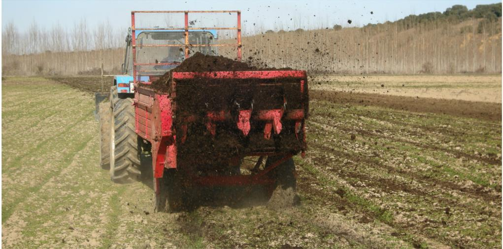
**Figura 60. Distribución de materia orgánica con remolque esparcidor de eje horizontal**
