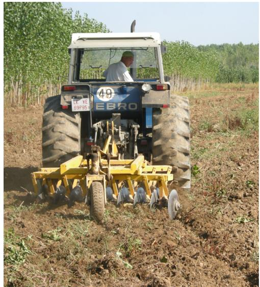
**Figura 90. Labor con grada de discos**
