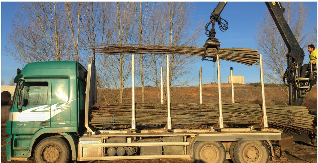
**Figura 83. Carga de plantas con autocargador**
