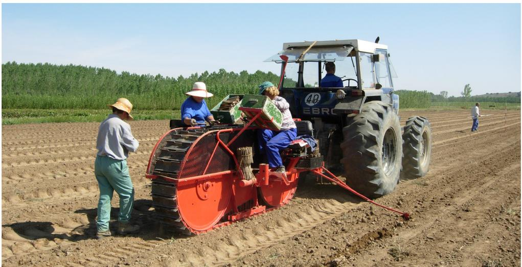
cilindro de alojamiento y, al avance del chasis, al discurrir unos rodillos laterales por unos planos inclinados que forman parte del mismo chasis, obligan al plantador a oprimir la estaquilla, en posición vertical, hasta que queda introducida en el suelo. Esta máquina se completa con el acoplamiento al chasis de dos asientos para los operarios que abastecen de estaquillas a la misma y dos soportes que tienen la función de sujetar los cajones en donde van las estaquillas que se van a plantar.
