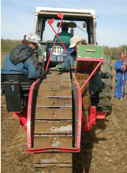
**Figuras 38 y 39. Máquina plantadora de estaquillas**
