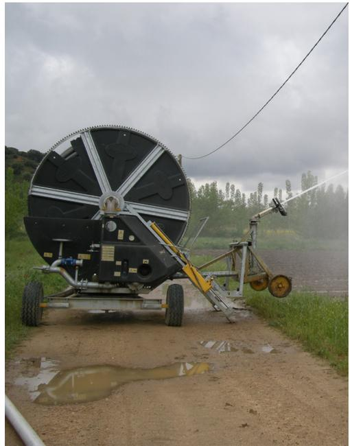
**Figura 54. Cañón de riego por aspersión con enrollador móvil**
