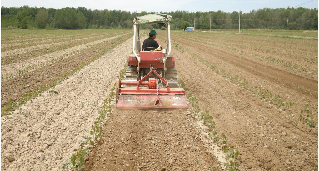
**Figura 44. Labor con rotovator**
