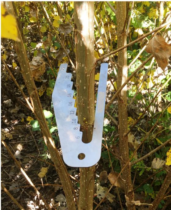
**Figura 95. Calibrado del diámetro de la vareta**
